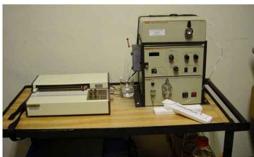
Figura 1. Analizor HPLC din prima generație Sistem HPLC model GA 400 www.chem.purdue.edu
