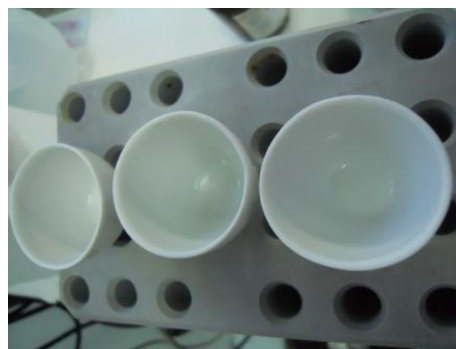
Figura 14. Evaporarea probelor în creuzete până la sec
