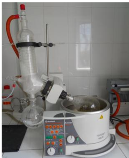
Figurile 21-22. Evaporarea probei de apă pe baie de ulei cu aparatul Heidolph Laborota 4003 control
