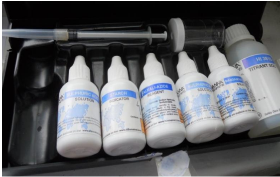
Figura 9. Kit de determinare a oxigenului dizolvat HI3810 (Hanna Instruments)
