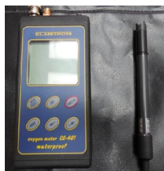
Figura 2. Aparat pentru determinarea oxigenului dizolvat, model Elmetron CO-401
