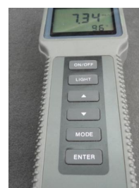
Figura 1. Aparat pentru detectarea temperaturii și oxigenului dizolvat model YSI 55
