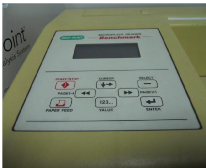
Figura 17. (detaliu panel). Spectrofotometru Benchmark utilizat pentru citirea probelor
