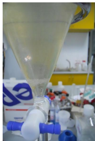
Figura 28. Separarea straturilor, probă de apă – diclormetan
