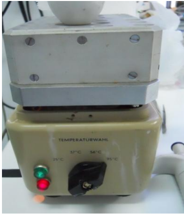
Figura 15. Dispozitiv utilizat pentru evaporare, setat la 95°C
