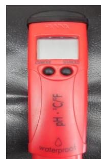
Figura 5. Ph-metru: pH/ EC/ TDS Waterproof Family utilizat în cadrul experimentului (Hanna Instruments)
