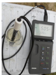
Figura 3. Aparat pentru detectarea conductivității, salinității și temperaturii, model Orion 115
