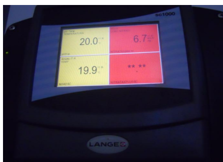
Figura 11. Aparat Lange SC1000 pentru înregistrarea parametrilor din bazinele piscicole
