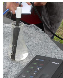
Figura 4. Tehnica de determinare a conductivității în condiții de teren
