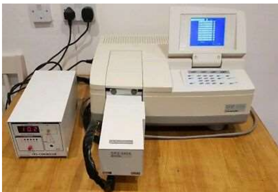
Figura 7. Spectrofotometrul Shimadzu, UV-VIS, Pharma-SPEC 1700
