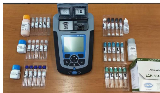
Figura 3. Spectrofotometrul portabil model DR 1900 (Hach, România) (Original)
