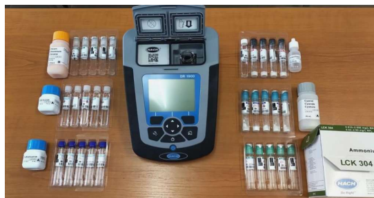
Figura 3. Spectrofotometrul portabil model DR 1900 (Hach, România) (Original)
