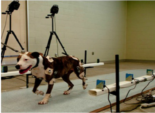
Figura 3. Analiza mersului – un câine ghidat peste plăci de forță încorporate într-un drum amenajat de 6m lungime. Se înregistrează semnale ale electromiografiei de suprafață, forțele GRF și informații cinematice. Sunt înregistrate simultan date despre flexori, extensori, GRF vertical de vârf, unghiuri articulare și mișcările fiecărui membru [132].
